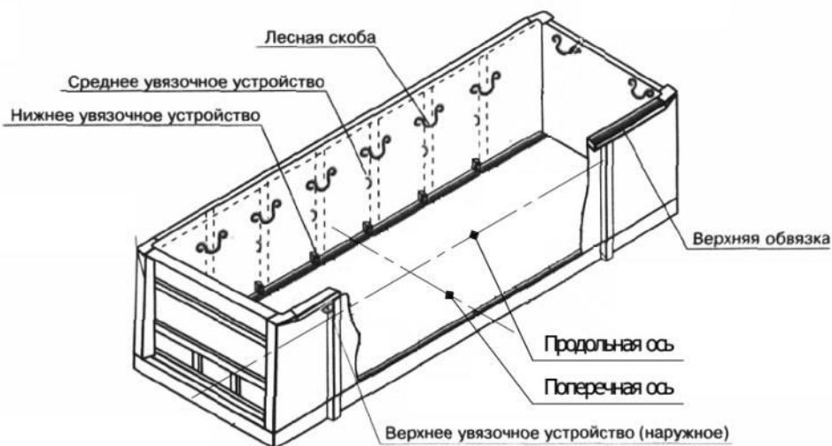
Рисунок 1 – Общий вид кузова универсального полувагона и расположение увязочных устройств.
