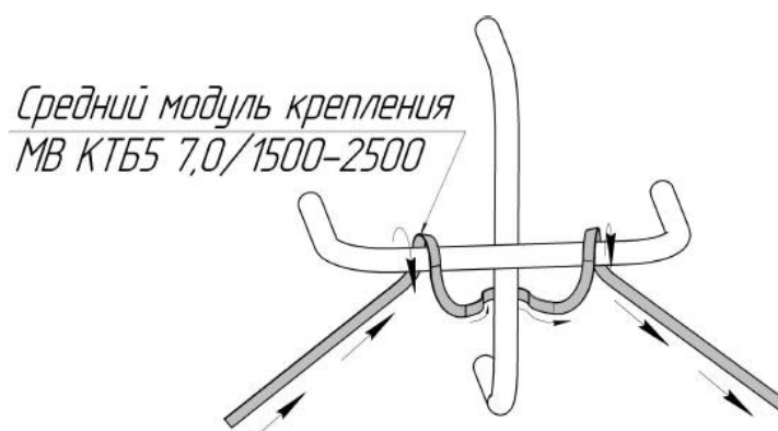
Рис. 30 – Установка среднего модуля за кронштейны заднего моста.
