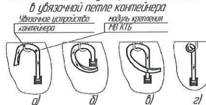
Рис. 1 Установка модуля крепления МВ КТБ1 в убязочной петле контейнера
