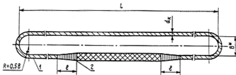
Рис. п.1.26. Универсальный строп, исполнение 2:
