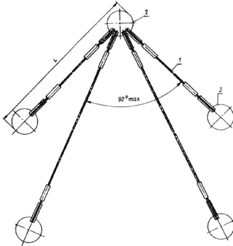
Рис. П.1.24. Четырехветвевой строп:
