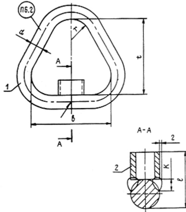
Рис. П.1.6. Звено типа Т, исполнение с одним упором:
