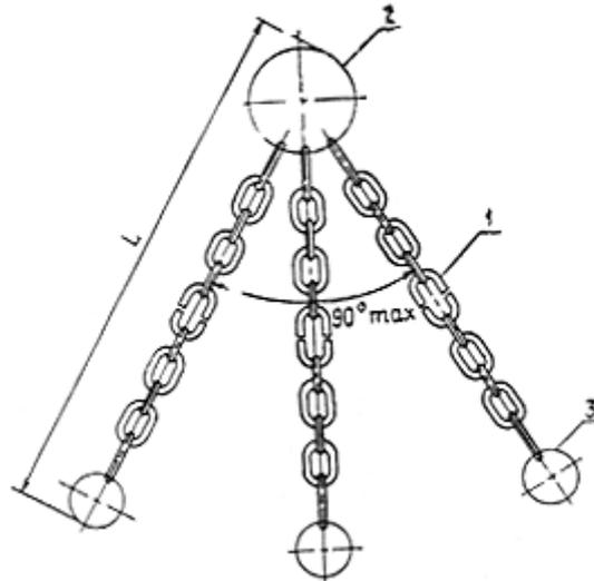
Рис. П.1.29. Трехветвевая строп:
