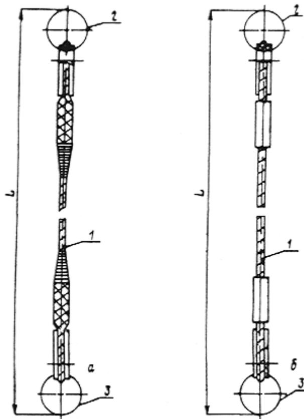
Рис. П.1.21. Одноветвевой строп (а - заделка концов каната заплеткой, б - опрессовкой алюминиевой втулкой):
