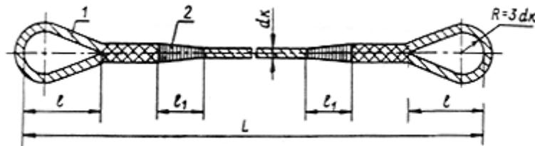
Рис. П.1.25. Универсальный строп, исполнение 1:
