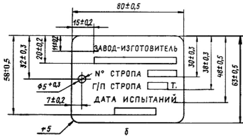
Рис. П2.1. Бирки маркировочные: а - для стропов грузоподъемностью до 3,2 т, б - свыше 3,2 т
